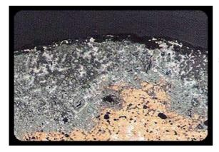
Tali manufatti metallici, se esposti agli agenti atmosferici o sepolti per molto tempo, possono dar luogo alla formazione di patine/incrostazioni di alterazione o di corrosione che vengono caratterizzate mediante analisi diffrattometrica XRD, dosaggio dei sali solubili e analisi spettrofotometrica all'infrarosso FT/IR.
